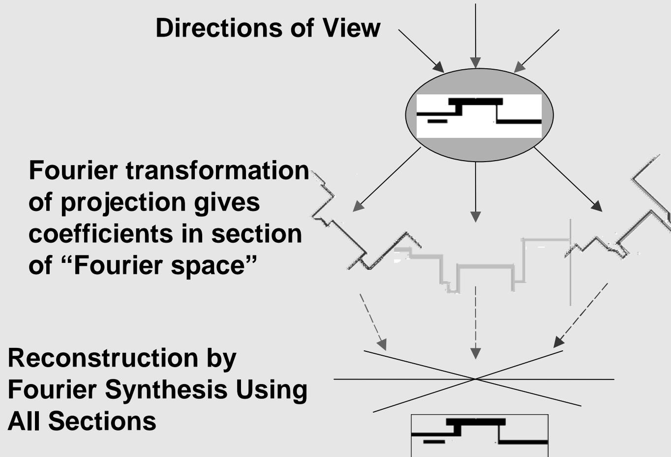
角。入射X射線透過樣品後在空間坐標系上有一個吸收投影圖  $P(X', \theta)$
