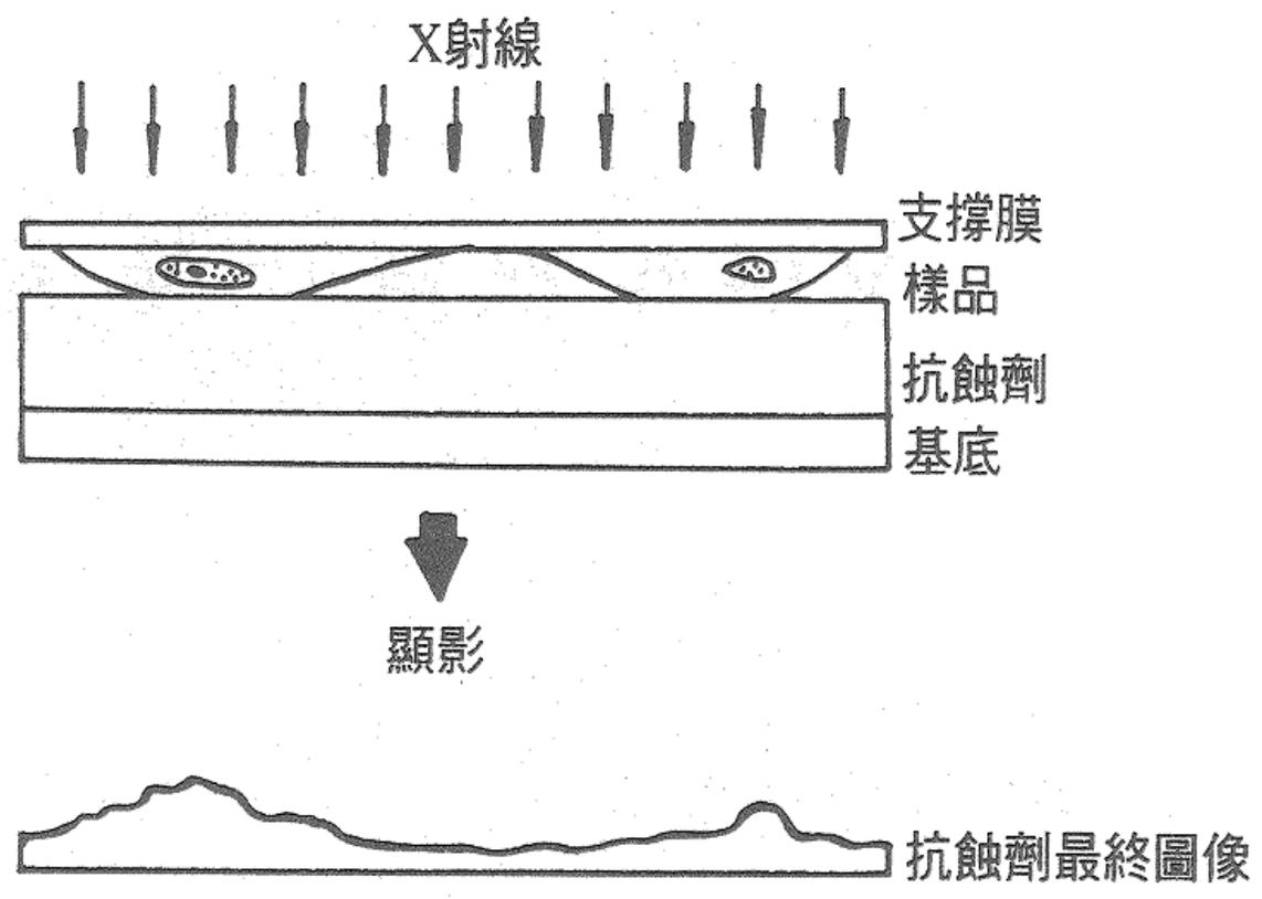
圖 4.1 接觸X射線顯微術原理圖
